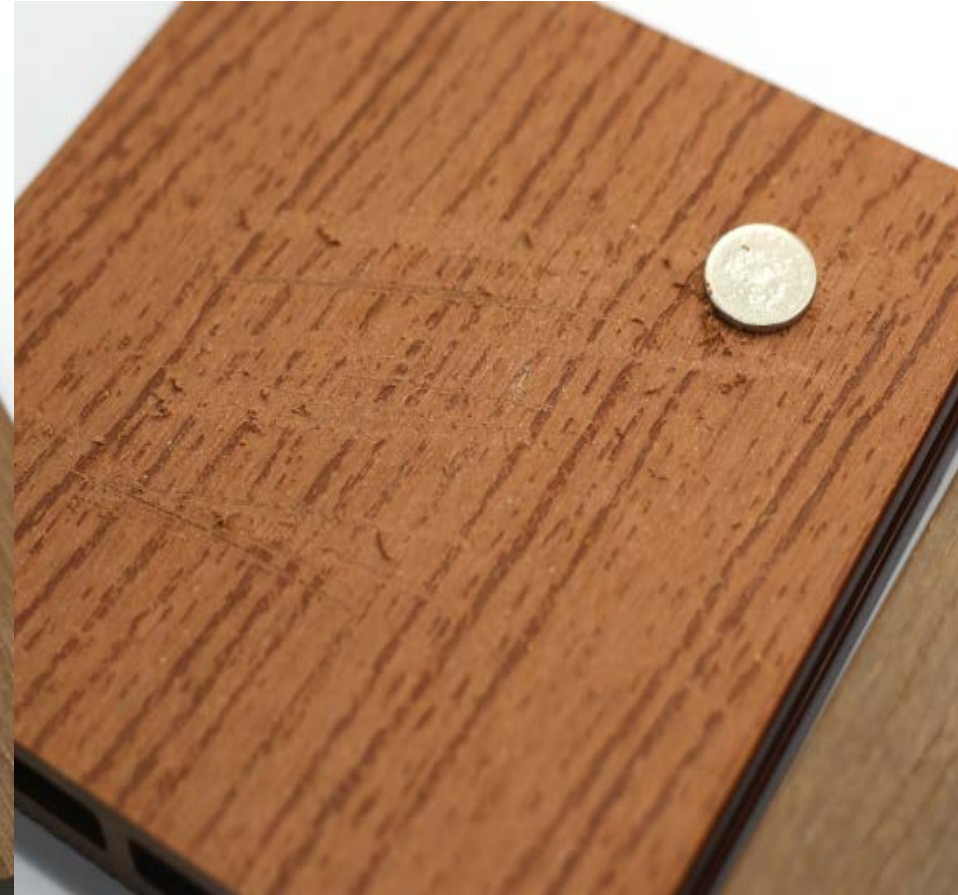
Deck convencional Marcas significativas y material desgastado
